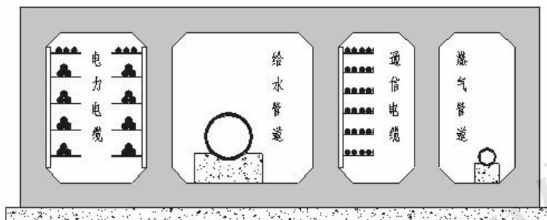
图1 干线综合管廊示意图
