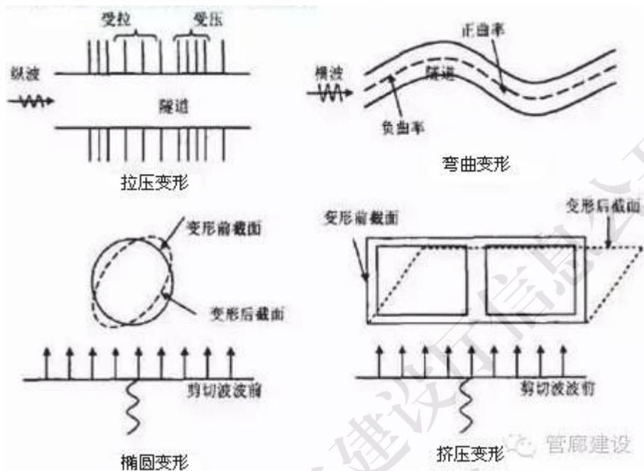
图9.4.1 地震作用下地下管廊结构主要变形形式
