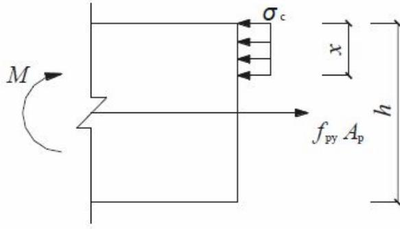
图9.6.5接头受弯承载力计算简图
