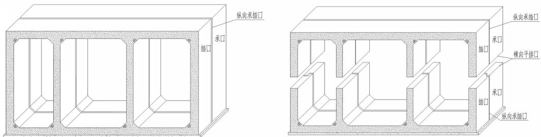
a) 整体式预制管廊 b) 节段预制管廊
