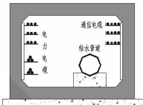
图2 支线综合管廊示意图
