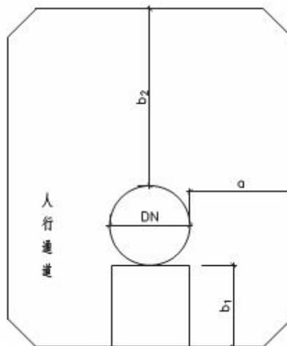
图 4.4.8 管道安装净距
