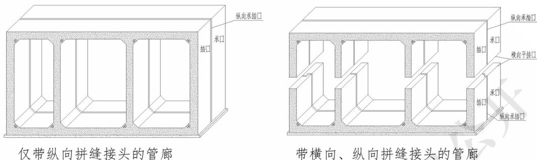
图1 预制拼装综合管廊的接缝类型
