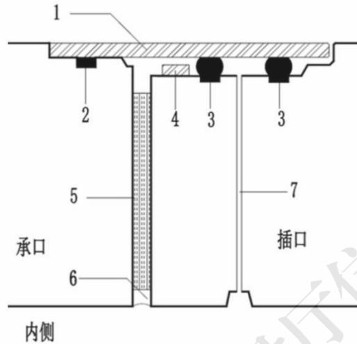
图10.4.2-3 钢承口承插接头密封防水构造
