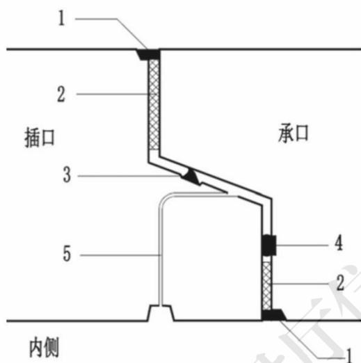
图10.4.2-1 纵向锁紧承插接头密封防水构造
