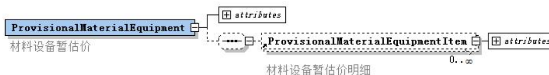
图 6.3.18 ProvisionalMaterialEquipment 元素关系
